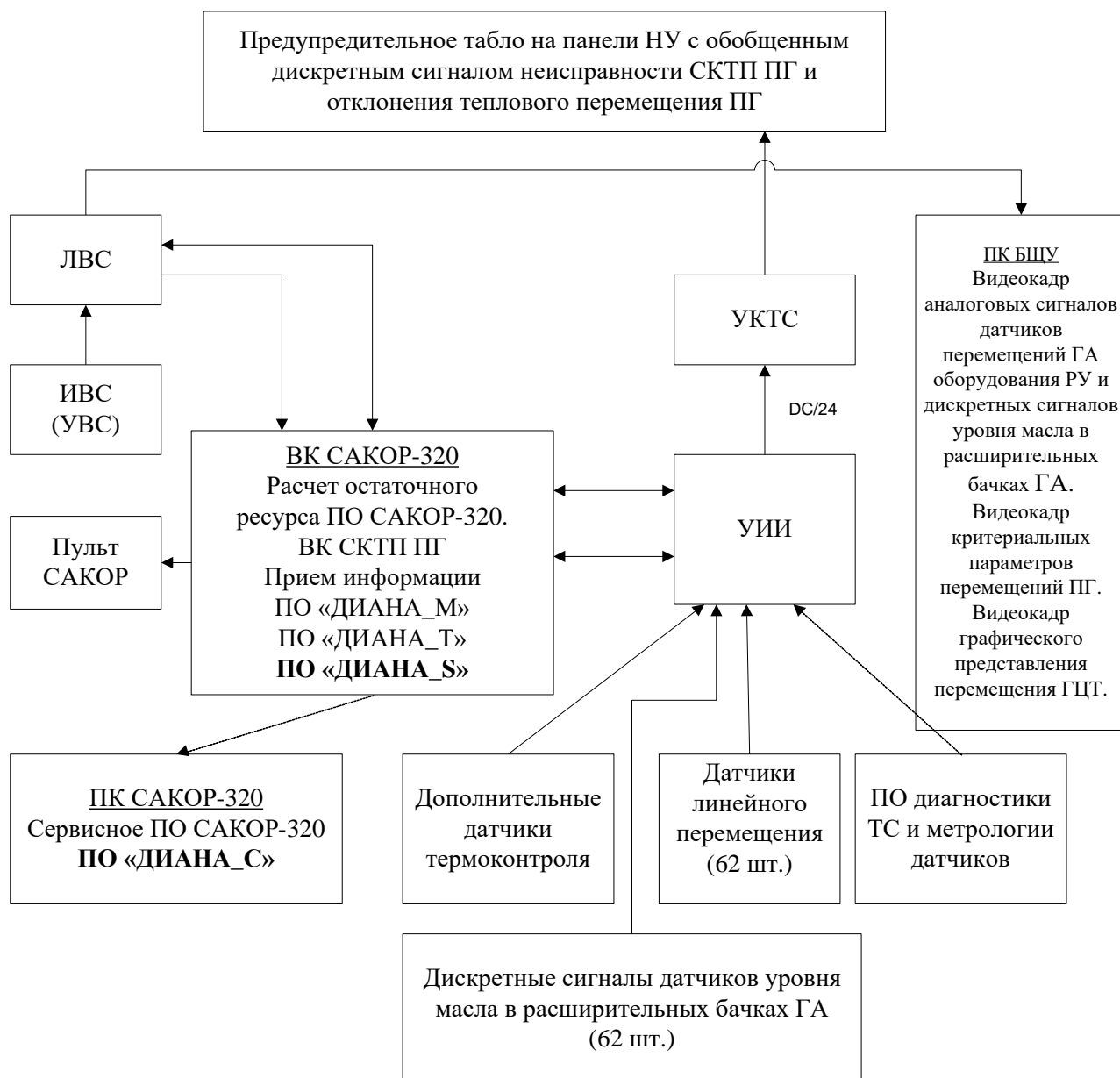
Рисунок 1 – Принципиальная схема передачи информации на ВК САКОР-320
